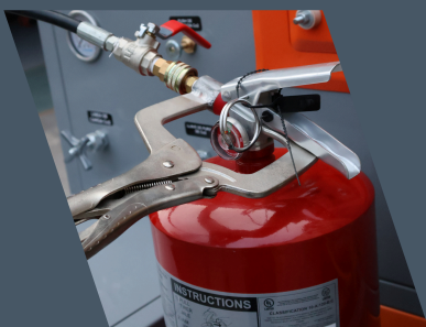
DESCARGA Y PRESURIZACION DE EXTINTORES
